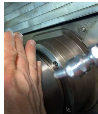
Aplicación perfecta para soplado de aire: sin fugas gracias a las juntas tóricas, incluso con el sistema sin fijar firmemente.
