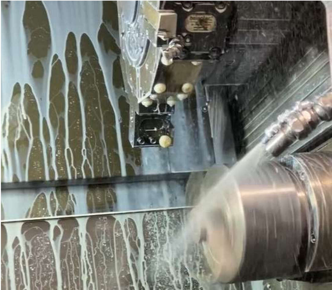
Sistema HECTO montado para el soplado por aire de plato de 2 garras en el subhusillo del torno CNC antes de la transferencia de la pieza desde el husillo principal.
