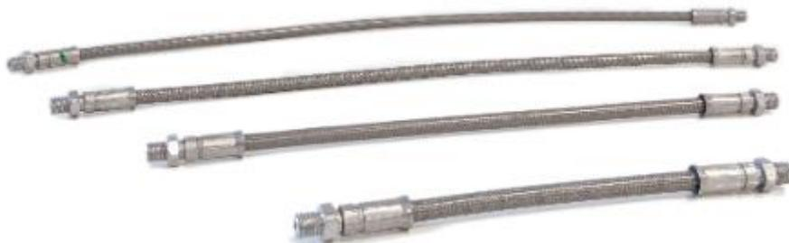
Set de tubos de distribución en cobre Diam. Ext.: 4 mm, Diám. Int.: 2 mm, con rosca en cada extremo M8x1 y acoplamiento a tubo de cobre con anillo de cierre de diám. 4 mm.
